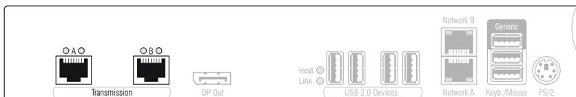
**Transmission:** Stecken Sie das Twisted-Pair-Kabel der Kategorie 6a (oder höher) ein, das an die Schnittstelle *Transmission* des Rechnermoduls angeschlossen ist.
