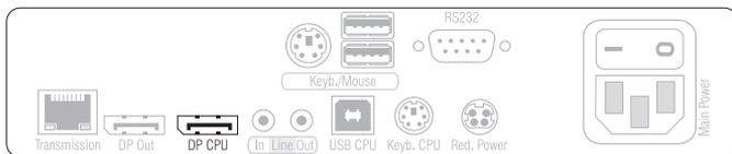
**DP CPU:** Verbinden Sie den Videoausgang des Rechners mit dieser Schnittstelle. Verwenden Sie hierzu das Kabel *DP-Cable-M/M-2*.
