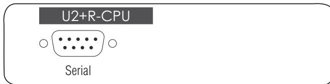
**Serial:** Verbinden Sie optional eine 9-polige serielle Schnittstelle des Computers mit dieser Schnittstelle. Verwenden Sie hierzu das RS232-Kabel.
