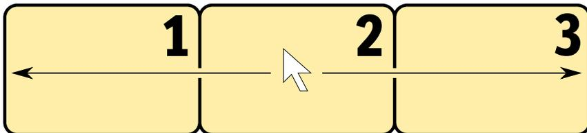
**BEISPIEL:** Bewegen Sie den Mauszeiger an den rechten Rand von **Monitor 2**, schaltet der KM-Switch auf Kanal 3, an dessen Rechner **Monitor 3** angeschlossen ist.
