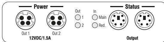
Die Mini-DIN-4-Buchsen der zwei anschließbaren Geräte werden via Power-Loop-Kabel mit einer Mini-DIN-4-Buchse der zentralen Stromversorgung verbunden.
