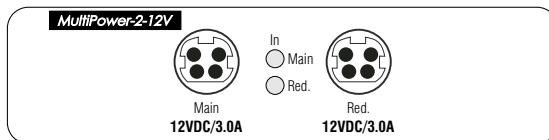
Mindestens eine externe Spannungsversorgung (Tischnetzteil) liefert die Spannung der zentralen Stromversorgung. Eine zweite, externe Spannungsversorgung gewährleistet den unterbrechungsfreien Betrieb, falls eine der beiden externen Spannungsversorgungen ausfällt.
