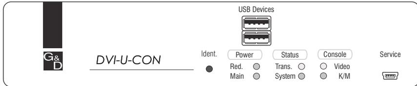
Die LEDs an der Frontseite des Arbeitsplatzmoduls geben Ihnen die Möglichkeit, den Betriebsstatus des Systems jederzeit zu kontrollieren.
