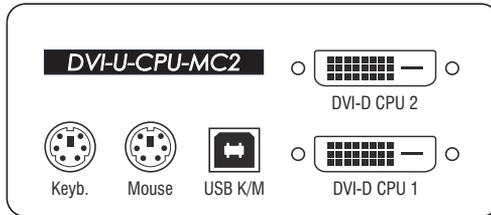
**HINWEIS:** Die Tastatur- und Maus-Signale können *wahlweise* über die PS/2-Schnittstellen oder die USB-Schnittstelle an den Computer übertragen werden.
