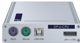
Der Datenstrom der am aufgeschalteten Arbeitsplatzmodul (nur **DVI-U-CON**- und **DP-U-CON**-Serie) angeschlossenen USB-Geräte wird mit max. 16 Mbit/s an den Computer übertragen.
