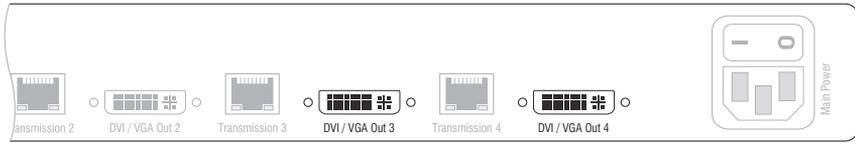
**DVI/VGA Out 3:** Schließen Sie den dritten Monitor des Arbeitsplatzes an.
