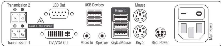
Auf der Rückseite des Arbeitsplatzmoduls befinden sich an den *Transmission*-Schnittstellen zusätzliche Status-LEDs. Diese LEDs haben folgende Funktion:
