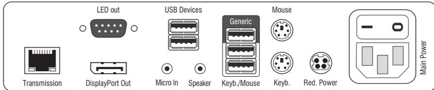
**HINWEIS:** Tastatur und Maus des Arbeitsplatzes können wahlweise über die PS/2- oder die USB-Schnittstellen des Arbeitsplatzmoduls angeschlossen werden.
