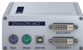
Der Datenstrom der am aufgeschalteten Arbeitsplatzmodul (nur **DVI-U-CON**- und **DP-U-CON**-Serie) angeschlossenen USB-Geräte wird mit max. 16 Mbit/s an den Computer übertragen.
