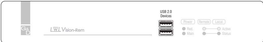
**USB 2.0 Devices:** Schließen Sie ggf. bis zu zwei USB-Geräte an der Frontseite an.
