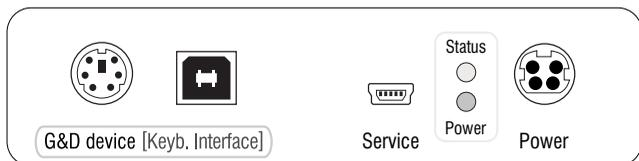
**G&D device:** Verbinden Sie das mitgelieferte PS/2- oder USB-Anschlusskabel mit dieser Schnittstelle und der PS/2- bzw. USB-Tastatur-Schnittstelle des kompatiblen G&D-Gerätes.
