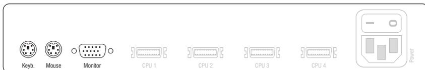
Abbildung 2: Schnittstellen am Slave-Switch zur Verbindung mit dem Master-Switch
