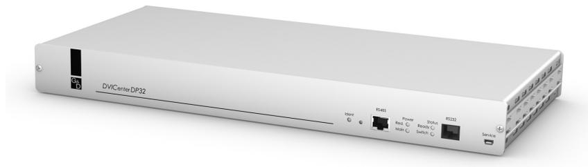
Die Aufschaltung eines Arbeitsplatzmoduls auf ein Target-Modul wird durch das Zentralmodul gesteuert.
