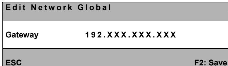
Tragen Sie nun in der Zeile Gateway die IP-Adresse des Gateways ein. Steppen Sie dazu entweder mit den **Pfeil rechts/Pfeil links**-Tasten oder der **TAB**-Taste auf einer der vier Felder. Durch Drücken der **ENTER**-Taste setzen Sie jedes einzelne Feld in den Editiermodus und die Schriftfarbe wechselt zu gelb.
