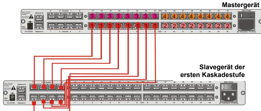
Hier werden die CPU-Ports 1 - 8 über jeweils ein CAT-Kabel (somit insgesamt acht CAT-Kabel) mit dem Slavegerät verbunden. Dieses CAT-Kabel wird im Slavegerät in die RJ45-Buchsen für den Konsolenanschluss gesteckt.
