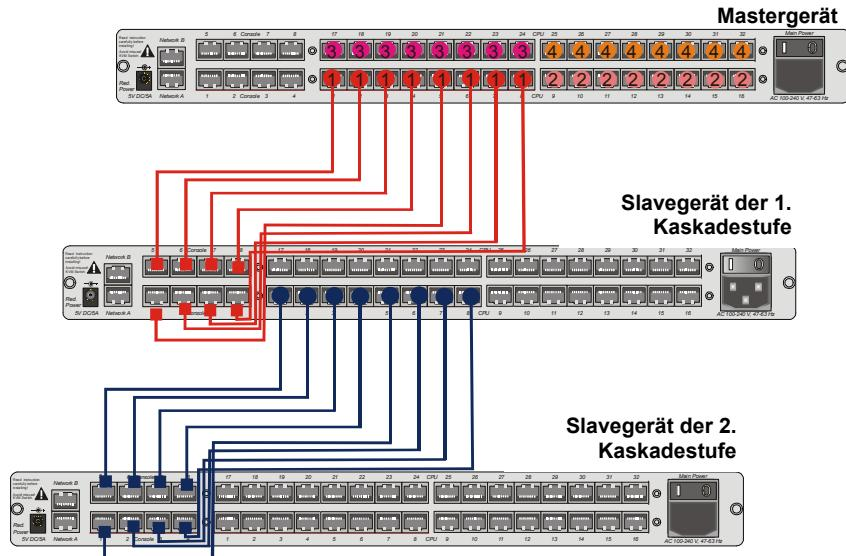
Der Anschluss der Targets an die Slavegeräte erfolgt analog zu dem in [Kapitel 2.1](#) beschriebenen Verfahren.
