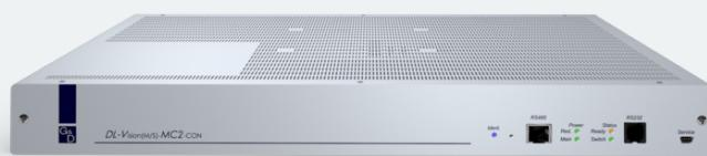
Die KVM-Extender der DL-Vision-Serie verlängern völlig unkomprimiert, pixelperfekt und latenz- sowie verlustfrei Tastatur-, Video- und Maus-Signale sowie weitere Peripheriedaten (z. B. Audio und USB) über eine dedizierte Fiber-Verbindung (bis zu 10.000 m). Ein Extendersystem besteht aus einem Rechnermodul (CPU) und einem Arbeitsplatzmodul (CON). Die DL-Vision-Serie unterstützt DualLink-DVI für hochauflösendes Video bis zu 2560 × 1600 (60 Hz) oder 4096 × 2160 (30 Hz).
